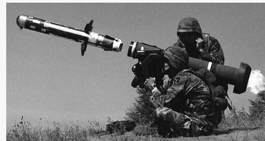
1 pav. Išliekanti „Javelin“ raketa išskleidžia sparnelius. Po to gale išsiskleidžia stabilizatoriai ir, nutolus saugiu atstumu, pradeda veikti pagrindinis variklis, kurio karštos išmetamosios dujos nepakenkia šauliui
