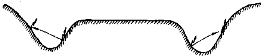
2.7 pav. Radijo stočių išdėstymas griovyje, dirbant su kaištine antena
