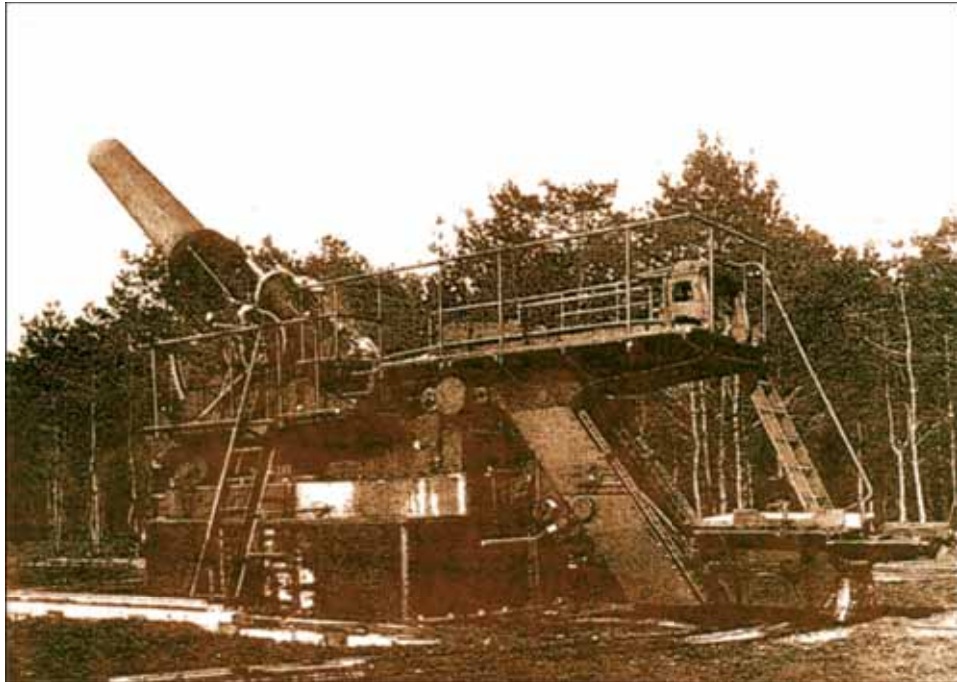
45. Vokiečių 420 mm mortyra „Gama Gerät“ („Didžioji Berta“). 1914–1918 m. VDKM
