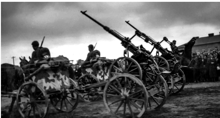
Priešlėktuviniai 20 mm 1934 m. modelio „Oerlikon“ (Šveicarija) automatiniai pabūklai ir jų vežimai (Lietuva), dažyti maskuojamosiomis dėmėmis (VDKM)
