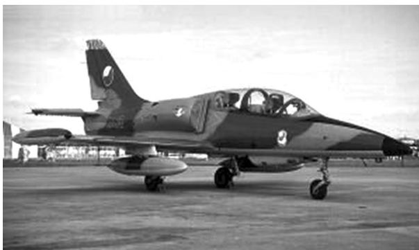
2.33 pav. Lietuvos karinių oro pajėgų čekiškas reaktyvinis lėktuvas L39 „Albatros“. Svoris 3,5 t, greitis 750 km/h, pakilimo aukštis apie 10,5 km [48].
