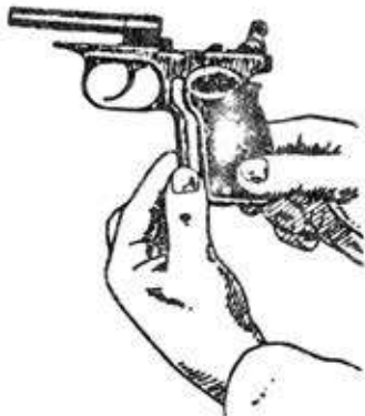
30 pav. Rankenos kriaunų atskyrimas nuo pagrindo
