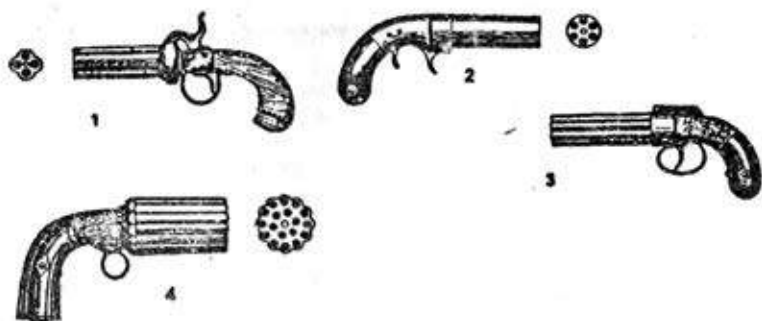
7 pav. Kapsuliniai pistoletai su besisukenčiais keliais vamzdžiais: 1 - Engholm, su gaiduku, atlaužiamu ranka, ir keturiais vamzdžiais, sukamais ranka (Švedija); 2 - Behon, su gaiduku apačioje; 3 - Allen, gaidukas atlaužiamas ir paleidžiamasis-smogliamasis mechanizmas suka vamzdžius; 4 - Marietta, 1837 m., 18 vamzdžių (Belgija)
