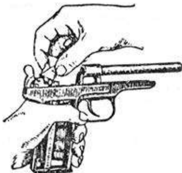
77 pav. Perduodančiosios svirties nuėmimas
