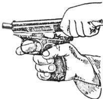
26 pav. Vamzdžio su spyruokle įkišimas į spygos kanalą
