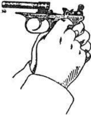
28 pav. Griebtuvo spyruoklės kabliuko nuėmimas nuo spynos laikiklio
