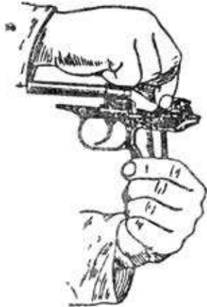
32 pav. Galduko atskyrimas nuo rėmo
