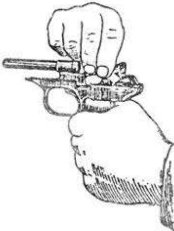
33 pav. Nuleistuko traukės su atlaužiamąja svirtimi atskyrimas nuo rėmo
