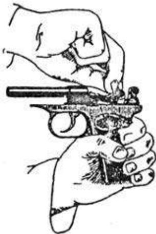
29 pav. Griebtuvo ir spynos laikiklio atskyrimas nuo rėmo
